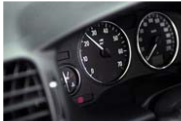
Figure 4.1 : engager le rapport supérieur avant 2 000-2 500 tr/min (tours par minute = régime du moteur)
