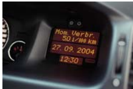
Figure 4.7 : affichage de la consommation réelle de carburant sur l'ordinateur de bord
