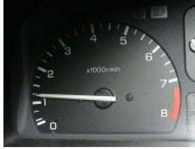
Figure 3.2 : compte-tours indiquant le régime réel du moteur
