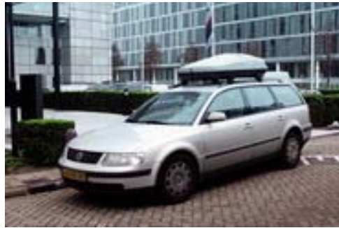
Figure 4.4 : même les coffres de toit aérodynamiques augmentent la consommation de carburant
